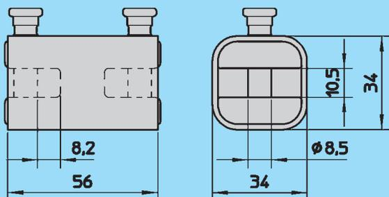
PER CATENE con sezione da mm. 5 a mm. 8
