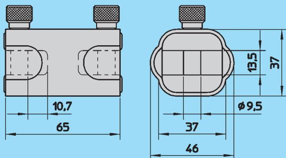
PER CATENE con sezione da mm. 7 a mm. 10,5
